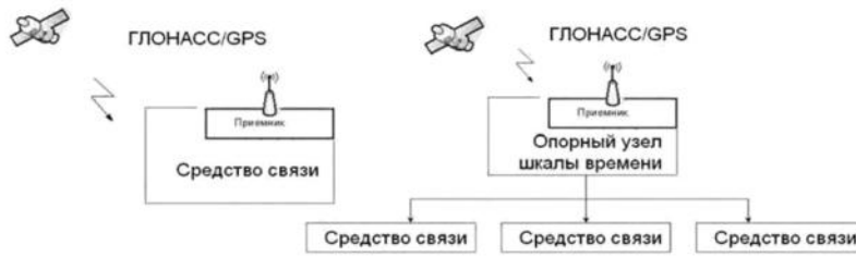
Рис. 2. Организация временной синхронизации сетей связи посредством ГНСС ГЛОНАСС/GPS
